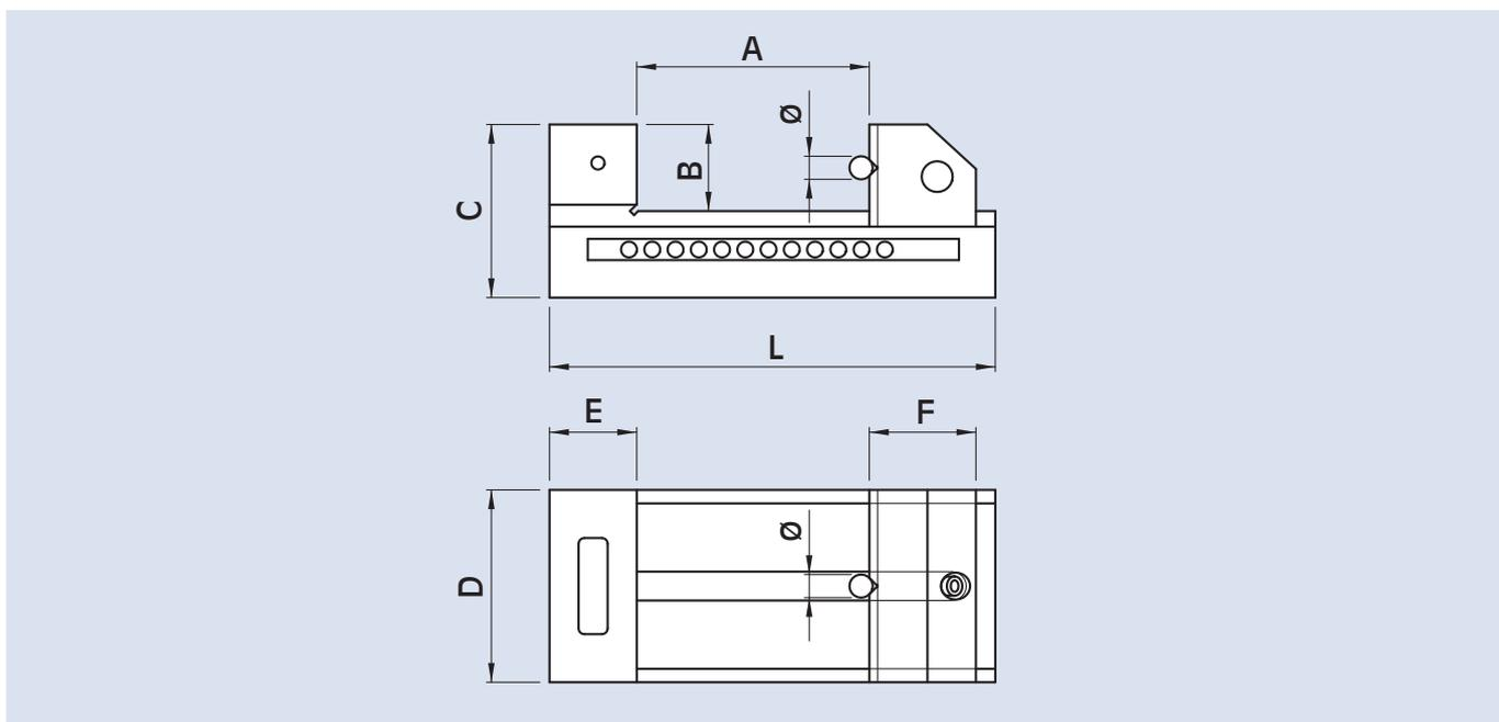
Attrezzature di bloccaggio costruite interamente in acciaio trattato a 60 HRC e finemente rettificate adatte a qualsiasi tipo di lavorazione di rettifica, elettroerosione, fresatura.
